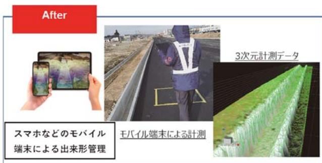
図9 スマホなどの汎用モバイル機器を活用した出来形管理のデジタル化
