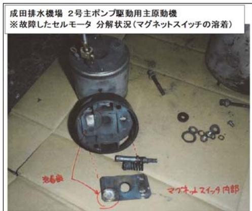
図-4 故障した2号原動機セルモータ
