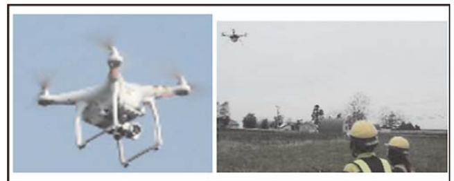
図4 ドローンによる3次元測量
