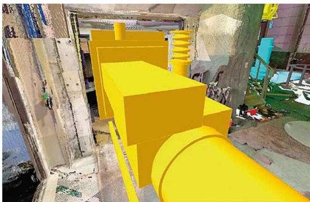
図-11 自家発電機の搬入シミュレーション
