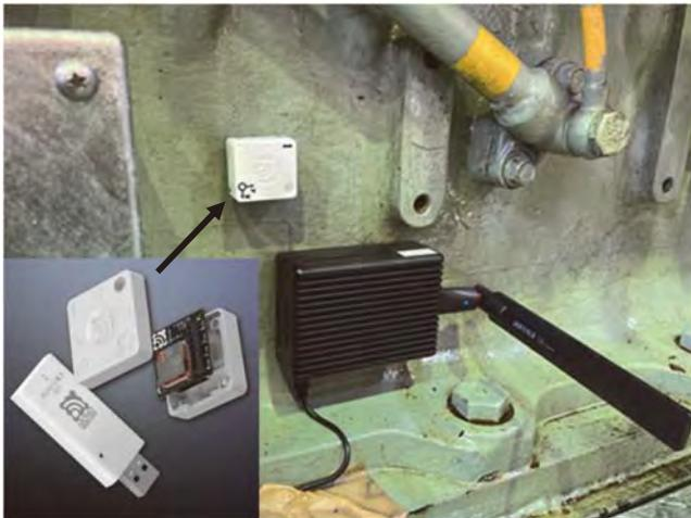
写真-2 無線型加速度センサ
