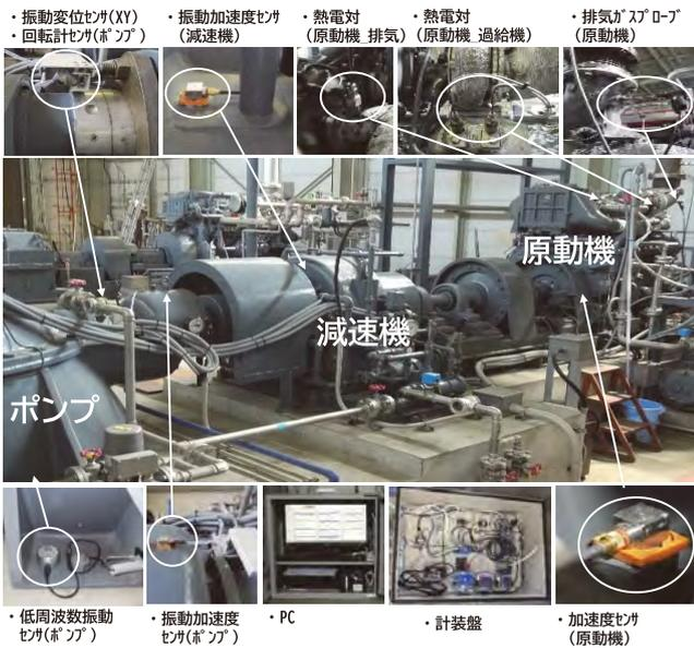
写真-1 状態監視モニタリングシステム設置事例
