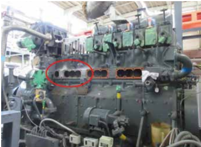
写真7、8 主原動機凍結破損状況（月寒排水機場）※ 矢印部分が凍結膨張によるエンジンブロックの亀裂
