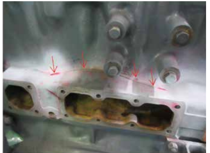
写真7、8 主原動機凍結破損状況（月寒排水機場）※ 矢印部分が凍結膨張によるエンジンブロックの亀裂
