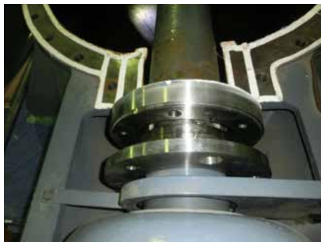
写－5 無給水形軸封装置
