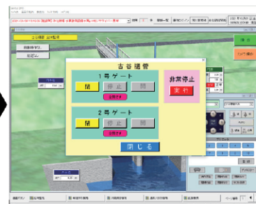
樋管操作画面（運転操作画面）
