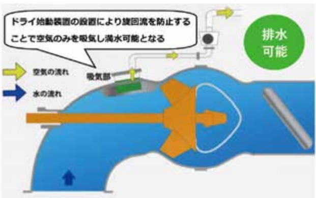
図-3 ドライ始動装置ありの改良吸気構造
