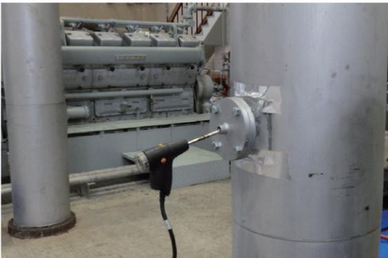
写-4 排気ガス測定口と挿入状態の測定プローブ
