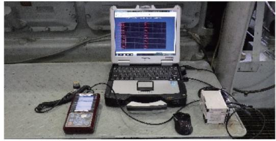
写-3 AE計測装置
