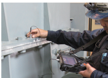
図－8 マグネット式センサによる振動計測
