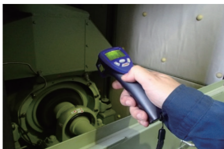
図－9 非接触赤外線温度計による計測
