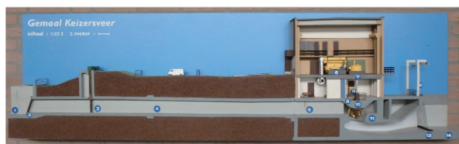
写－２ カイザースフィアポンプ場 断面図
