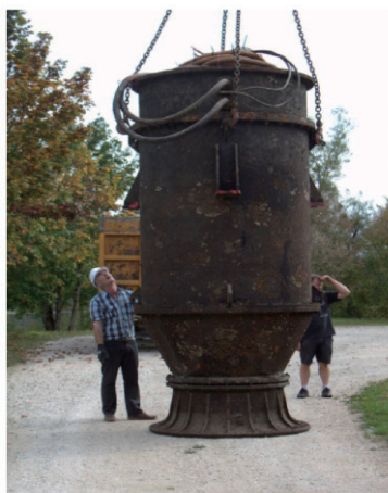
写－２ 水中ポンプ 外観
