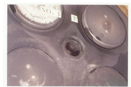
70%負荷 (Pme 1.7MPa) 30分間ブローオフ運転
