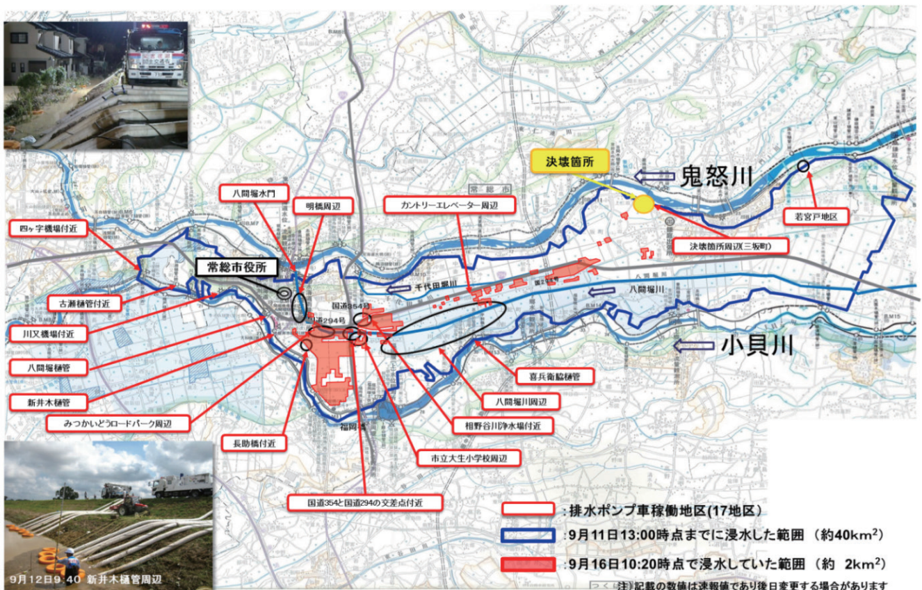
図-8 鬼怒川での排水ポンプ車稼働状況
