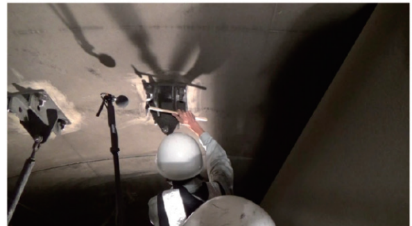
写-3 ジェットファンの打音収録状況
