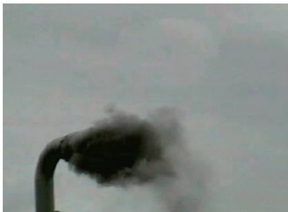
写-5 起動時、煙突よりの煙
