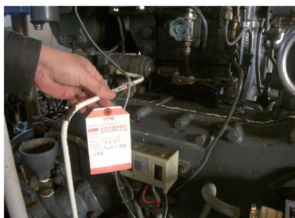
図－14 ポンプ設備の原動機へのエフ付け事例
