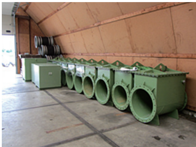
写－2 移動式 銅板製逆止弁×10台
