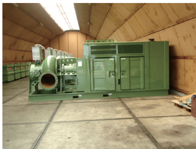
写－1 φ600 移動式ポンプ×10台
