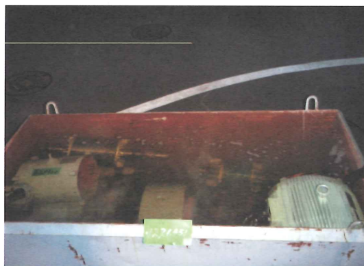
写-4 電動機煮沸状況(工場内作業)
