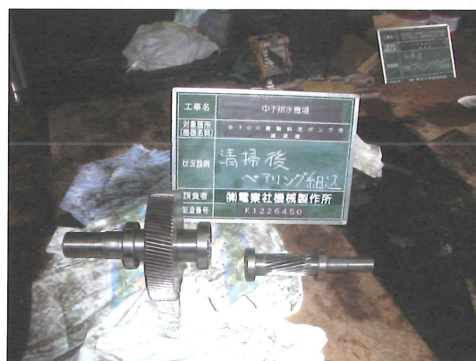
写-5 減速機整備：歯車は清掃再利用
