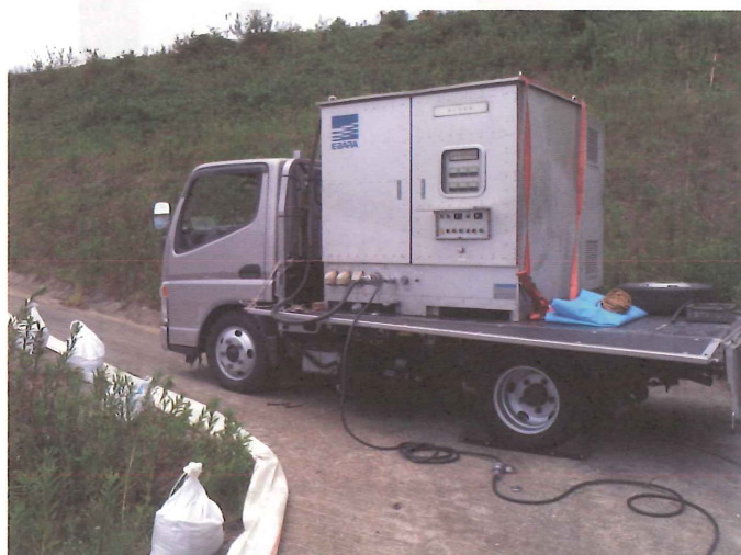
【 10\text{m}^3/\text{min} （全揚程 10\text{m} ）ポンプ車（ポンプパッケージ1台搭載）の実施例】
