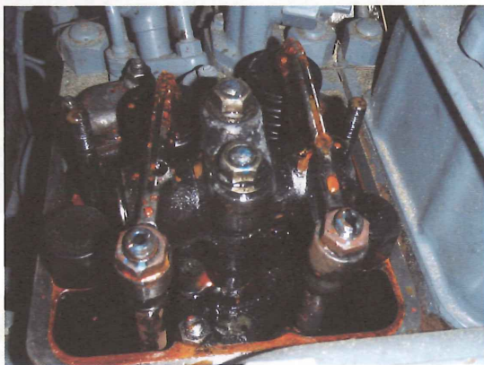
写-9 エンジンシリンダヘッド内部の発錆状況
