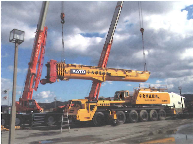
図－9 300t級クレーンの組立
