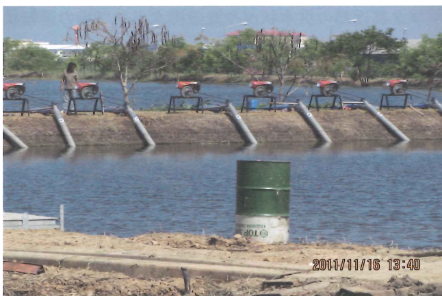
写-5 ②φ 150 斜軸ポンプ+耕運機用エンジン
