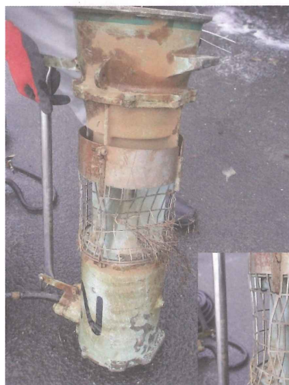
② ストレーナ損傷状況
