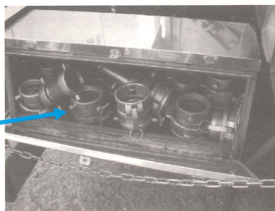
出典：第8回大規模水害に関する専門調査会資料より 写真-3 タンクローリー車が持ち運んでいる多数の接続金具
