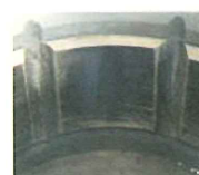
写-2 試験後の軸受
