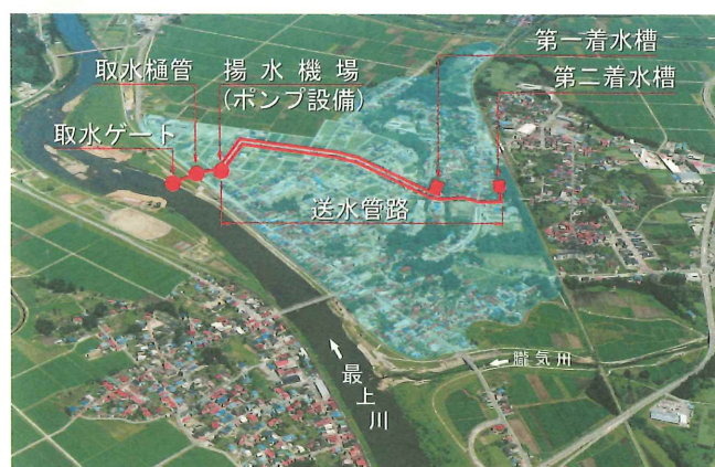
図－2 大石田地区消流雪用水導入施設概要図
