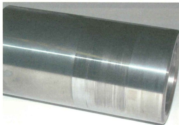
写二 気中運転後の超硬スリーブ摺動面
