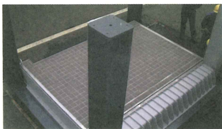
写一1 試作機 倒伏（平時）状態 （止水幅3.0m×止水高2.0m）
