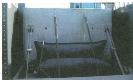
写一2 試作機 起立状態 背面 （止水幅3.0m×止水高2.0m）
