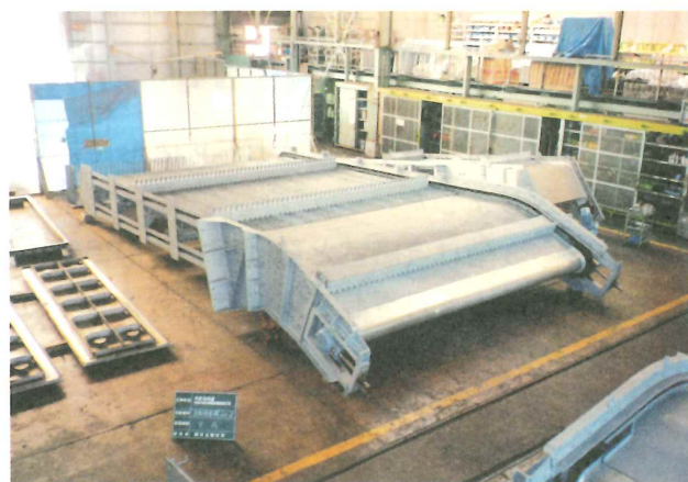
写真2 除塵機仮組立
