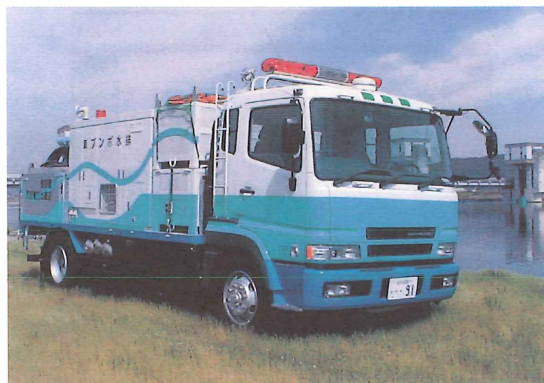
写-1 150m³/min排水ポンプ車外観
