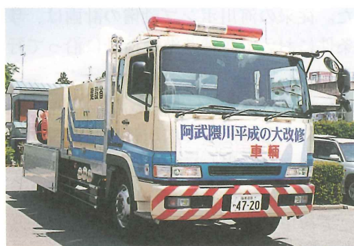
写一2 配備された排水ポンプ車
