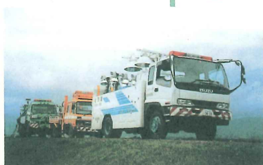
北陸地建から応援に来た照明車・作業車・排水ポンプ車
