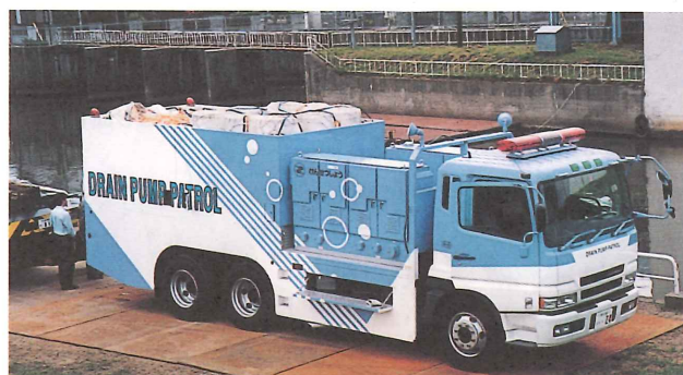
写-1 排水ポンプ車
