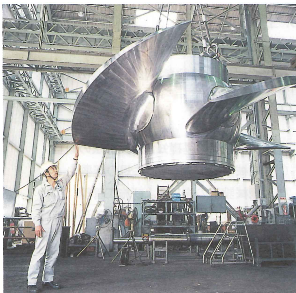
写一2 口径3600ミリ立軸可動翼軸流ポンプの羽根車
