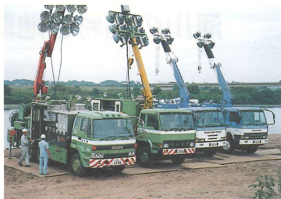
写-1 排水ポンプ車設置状況
