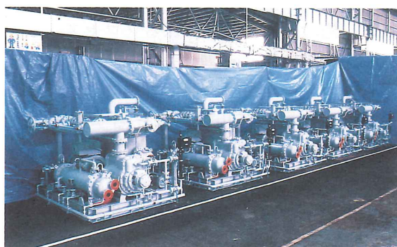
写－4 電力向復水器用真空ポンプ
