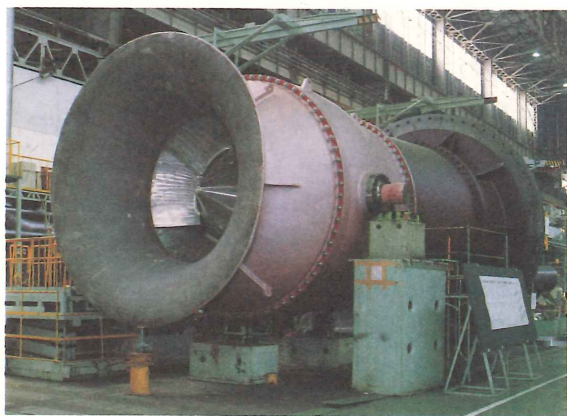
写-3 大口径(φ4100)循環水ポンプ
