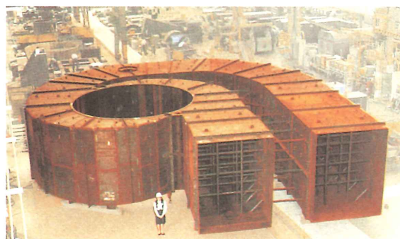
写－2 三郷排水機場向50m 3 /sポンプ
