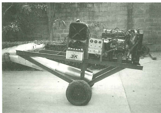
写一 三 エンジン掛ポータブル斜軸ポンプ
