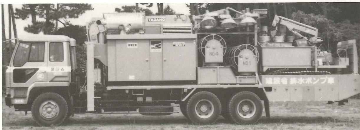
写-1 排水ポンプ車全容
