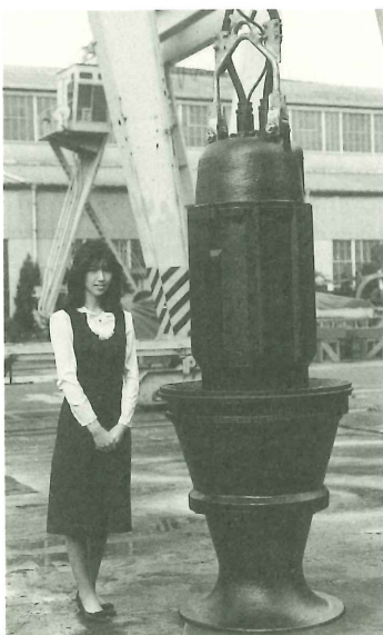
写－６ 救急排水ポンプ
